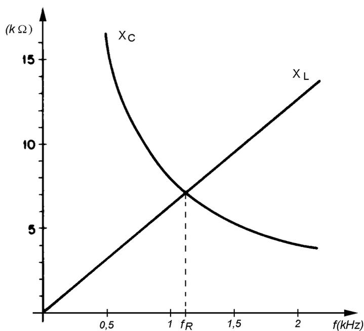
Esta frequência onde  $X_L$  é igual a  $X_C$  chama-se **frequência de ressonância**, representada pela notação  $f_r$  de acordo com a norma NBR 5453.
