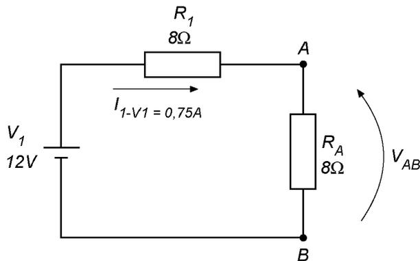
Utilizando a lei de Ohm, é possível calcular a tensão, entre os pontos A e B.
