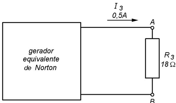
**Passos 3 e 4:** Cálculo da tensão e da potência dissipada em  $R_3$ .
