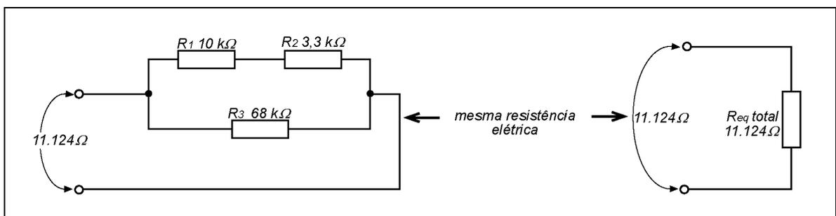
Aplicando-se a associação de resistências ou uma única resistência de 11.124 Ω a uma fonte de alimentação, o resultado em termos de corrente é o **mesmo**.
