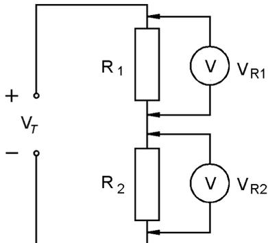
A tensão em cada resistor  $V_{R1}$  e  $V_{R2}$ , pode ser determinada a partir dos valores da tensão de entrada, dos resistores e utilizando a lei de Ohm.
