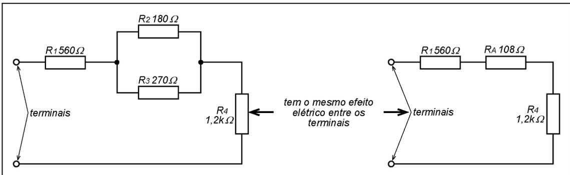
Ao substituir a associação mista original, torna-se uma associação em série simples, constituída pelas resistências  $R_1$ ,  $R_A$  e  $R_4$ .
