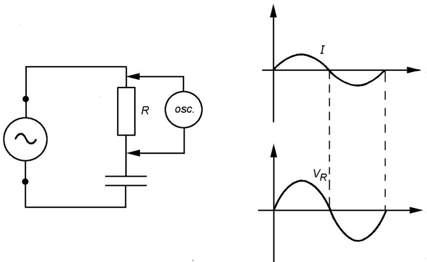
Sobrepondo os gráficos senoidais da corrente e da tensão no resistor nos mesmos eixos, observa-se facilmente este comportamento.
