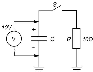
No momento inicial, o capacitor está carregado, apresentando uma tensão de 10V entre seus terminais. Como a chave S está desligada, a tensão sobre o resistor é zero e a corrente também.
