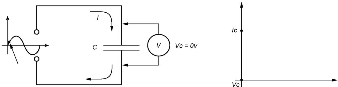
À medida que a tensão sobre o capacitor aumenta, a corrente de carga diminui porque as cargas já armazenadas no capacitor se opõem à entrada de novas cargas.
