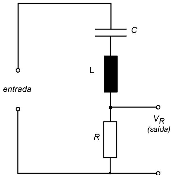
Nesse circuito, a tensão de saída ( $V_R$ ) atinge o seu valor máximo na frequência de ressonância, decrescendo à medida que a frequência aplicada à entrada se afasta da frequência de ressonância.
