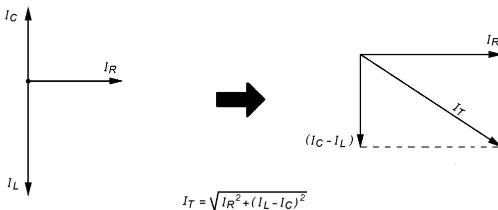
A ordem dos termos  $I_L$  e  $I_C$  na equação só é importante se for necessário isolar um destes termos.
