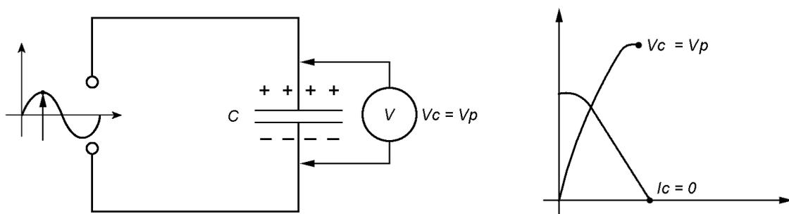
Observa-se pelo gráfico senoidal que a corrente do capacitor atinge o valor máximo ( $90^\circ$ ) antes que a tensão no capacitor atinja o valor máximo.
