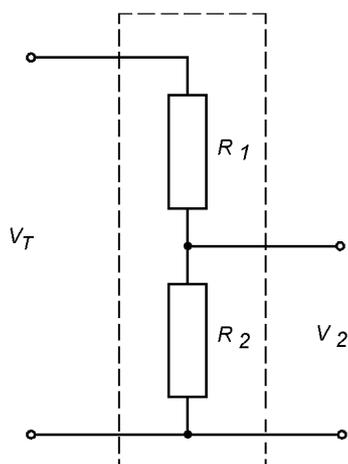
O circuito divisor de tensão serve para fornecer parte da tensão de alimentação para um componente ou circuito. Assim, com um divisor de tensão, é possível por exemplo, obter 6 V em uma lâmpada, a partir de uma fonte de 10 V.
