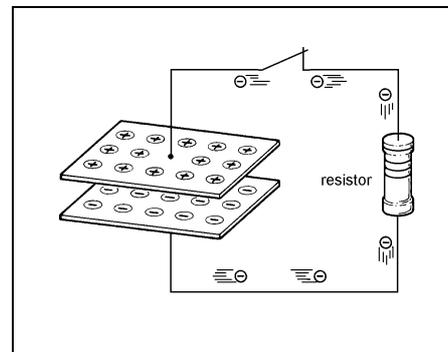
Isso se deve ao fato de que através do circuito fechado inicia-se o estabelecimento do equilíbrio elétrico entre as armaduras. Os elétrons em excesso em uma das armaduras, se movimentam para a outra onde há falta de elétrons, até que se **restabeleça o equilíbrio de potencial entre elas**.
