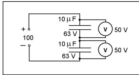
A **distribuição da tensão** nos capacitores ocorre de forma **inversamente proporcional à capacitância**, ou seja, quanto maior a capacitância, menor a tensão; quanto menor a capacitância, maior a tensão.
