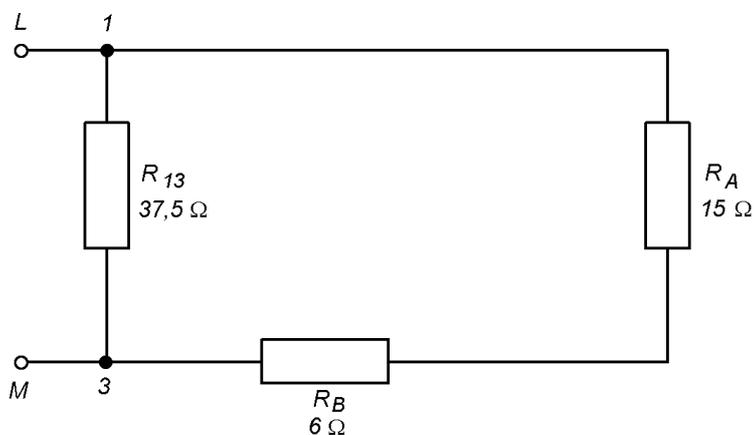
No circuito apresentado, os resistores  $R_A$  e  $R_B$  estão em série e podem ser substituídos por um único resistor. O resistor equivalente pode ser chamado de  $R_C$ , por exemplo.
