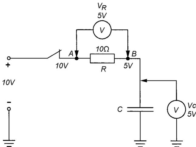
O circuito acima mostra que, com o crescimento da tensão sobre o capacitor, a ddp sobre o resistor diminuiu de 10 V no instante inicial para 5 V após algum tempo.
