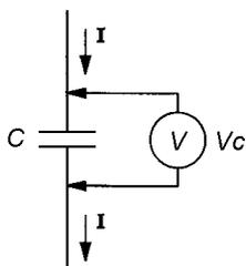
Assim, a forma como o capacitor se carrega depende fundamentalmente **da corrente de carga**. Vamos analisar o circuito a seguir, admitindo que, na condição inicial com a chave desligada, o capacitor esteja completamente descarregado.
