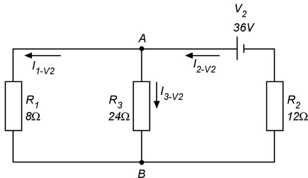
Vamos determinar agora, a resistência equivalente deste novo circuito. Os resistores  $R_1$  e  $R_3$  estão em paralelo e podem ser substituídos por um único resistor, que chamaremos de  $R_A$ .
