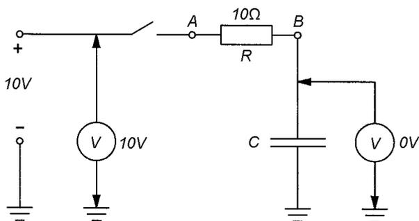
Quando a chave é ligada, os 10 V da fonte são aplicados à extremidade A do resistor. A extremidade B do resistor está a zero volt porque não há tensão sobre o capacitor. A diferença de potencial sobre o resistor é de 10 V ( $V_R = V_A - V_B$ ,  $V_R = 10\text{ V} - 0\text{ V}$ ).
