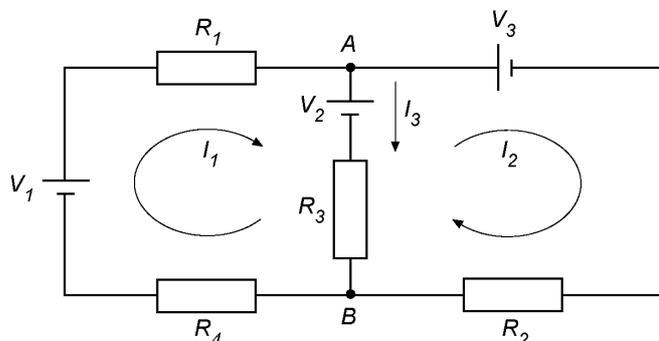
De acordo com a **segunda regra básica**, deve-se orientar as tensões nos bipolos elétricos do circuito, com os seguintes sentidos:
