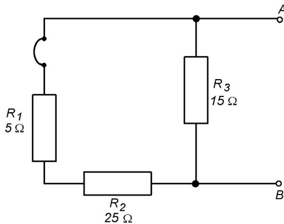
Na associação resultante, temos os resistores  $R_1$  e  $R_2$  em série, que podem ser substituídos por um resistor equivalente que vamos chamar de  $R_A$ .
