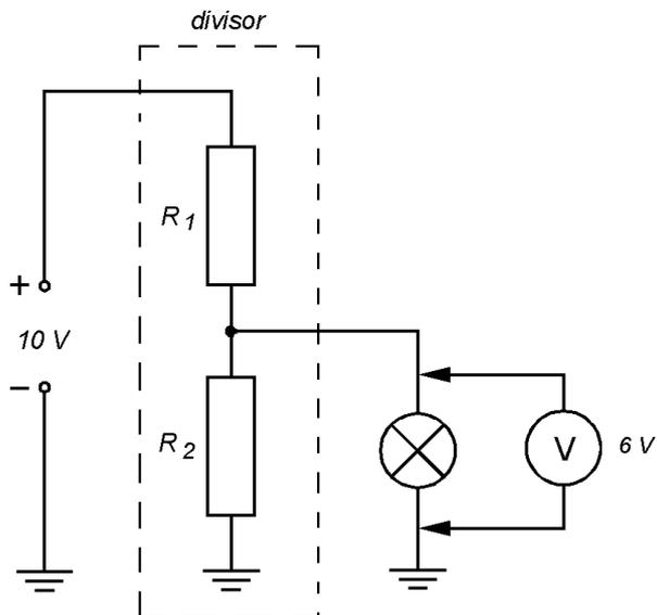
O circuito ou componente alimentado pelo divisor é denominado **carga do divisor**. A tensão fornecida pela fonte ao divisor chama-se **tensão de entrada**; a tensão fornecida pelo divisor à carga é a **tensão de saída**.
