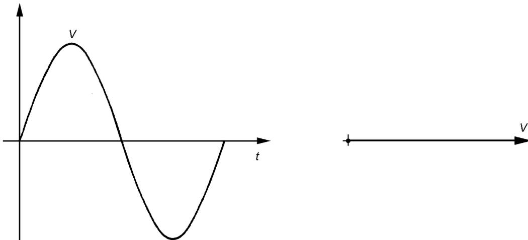
A aplicação de tensão ao circuito RLC paralelo provoca a circulação de corrente nos três componentes:
