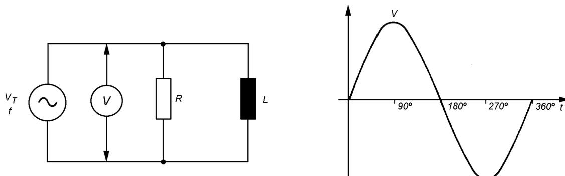
A tensão aplicada provoca a circulação de uma corrente no resistor ( $I_R$ ) que está em fase com a tensão aplicada.
