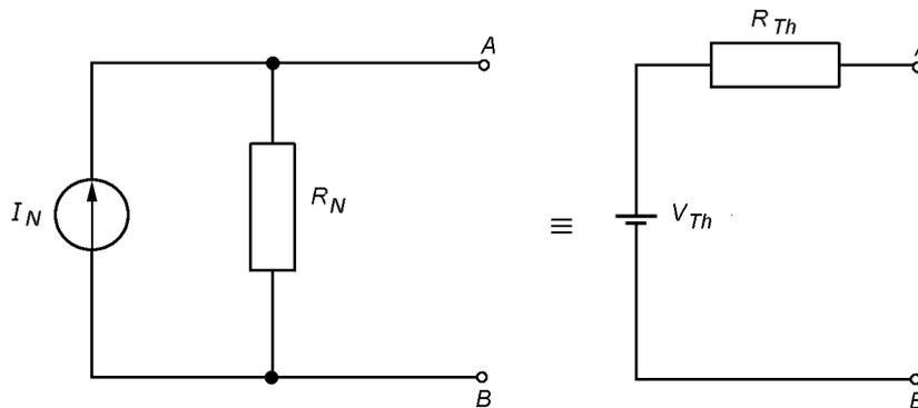
Para determinar o circuito do gerador equivalente, utilizam-se as seguintes equações:
