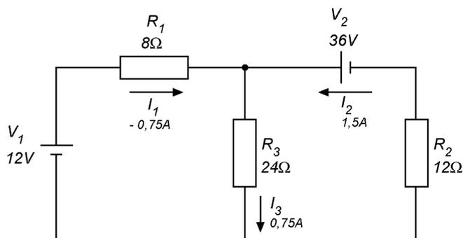
**Passo 3:** Calcular as tensões e potências dissipadas nos componentes.
