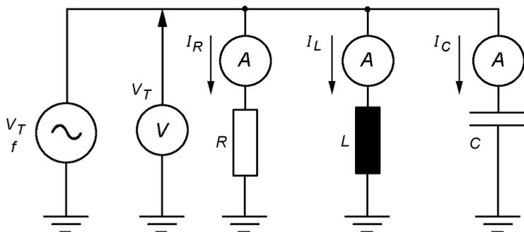
Essas três correntes dão origem a uma corrente total, fornecida pela fonte. Essa corrente é determinada por soma vetorial, uma vez que as três correntes estão defasadas entre si.
