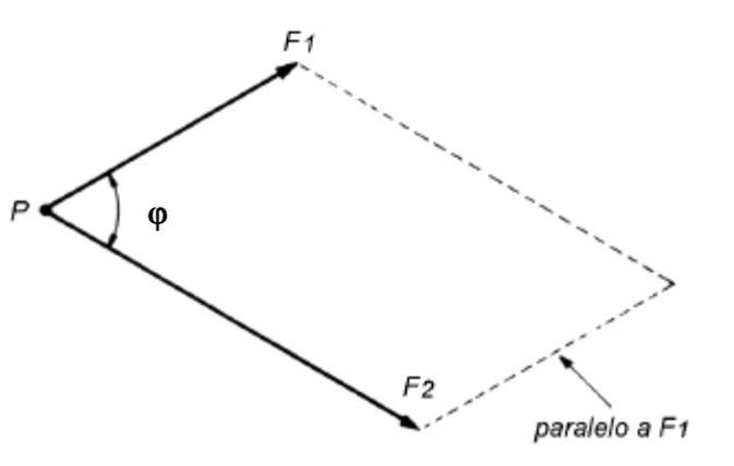
Forma-se assim um paralelogramo cuja diagonal é a resultante. Medindo a resultante com a mesma escala usada para os vetores que a compõem, obtém-se **o módulo da resultante**.
