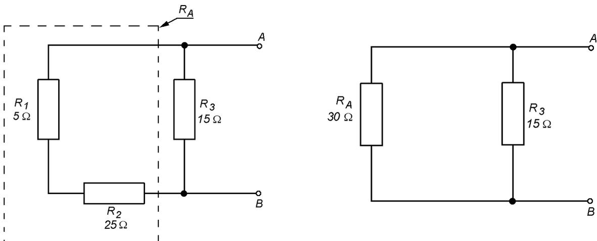
No circuito obtido, as resistências  $R_A$  e  $R_3$  estão em paralelo, e também podem ser substituídas por um único resistor equivalente.
