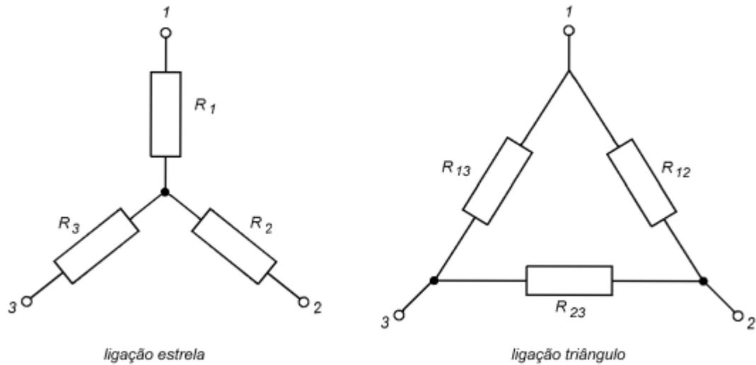
Para determinar os valores das resistências da associação em triângulo equivalente, as seguintes equações são usadas:
