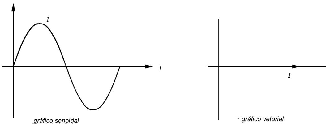
A circulação de corrente através do resistor dá origem a uma queda de tensão sobre o componente. Essa queda de tensão ( $V_R = I \cdot R$ ) está em fase com a corrente.
