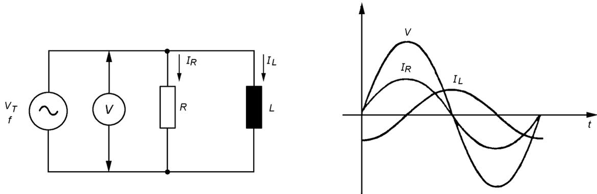
O gráfico senoidal mostra que **o circuito RL paralelo** se caracteriza por provocar uma **defasagem entre as correntes**. Essa defasagem é visualizada mais facilmente através do gráfico vetorial do circuito RL paralelo. Ele mostra que a corrente no indutor está atrasada  $90^\circ$  em relação à corrente do resistor.
