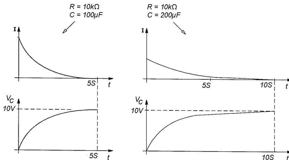
Se o tempo de carga é proporcional a R e a C, pode-se concluir que o tempo de carga é **diretamente proporcional a RC**. Usando valores de resistência em ohms e de capacitância em farads, a resposta da representação matemática será em segundos, ou seja:  $R (\Omega) \cdot C (F) = t (s)$ .
