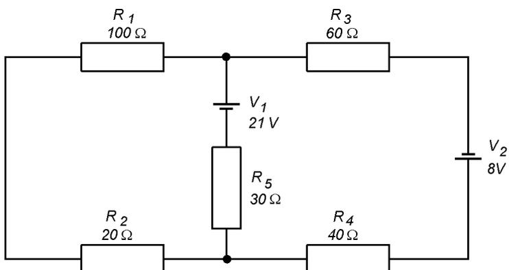
b) Determine a tensão no resistor  $R_2$ .
