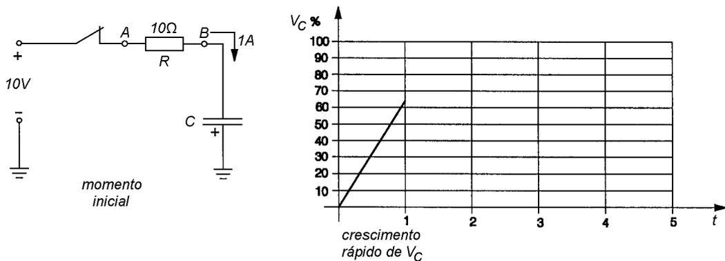
Após algum tempo, o acúmulo de cargas no capacitor provocará o surgimento de uma ddp entre as armaduras.
