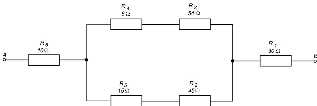
As associações em série  $R_3/R_4$  e  $R_2/R_5$ , podem ser substituídas respectivamente por um resistor cada uma, identificados, por exemplo por  $R_A$  e  $R_B$ .
