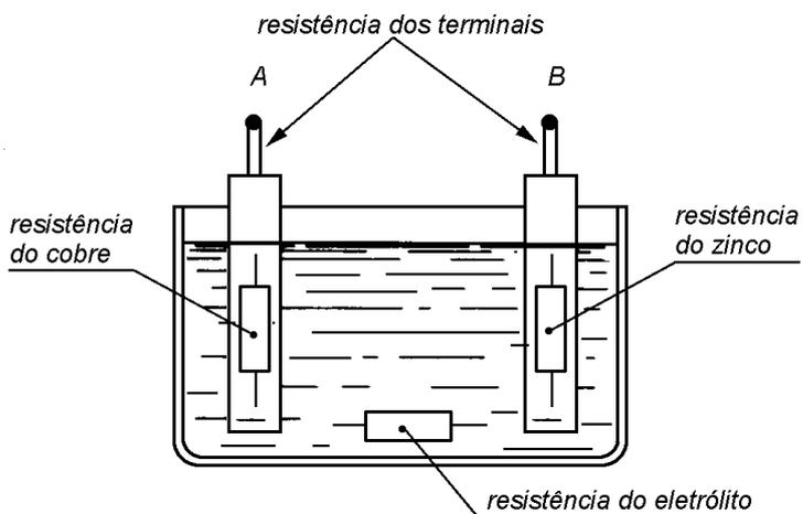
Desta forma, uma pilha pode ser representada como uma fonte de tensão em série com as resistências de seus elementos.
