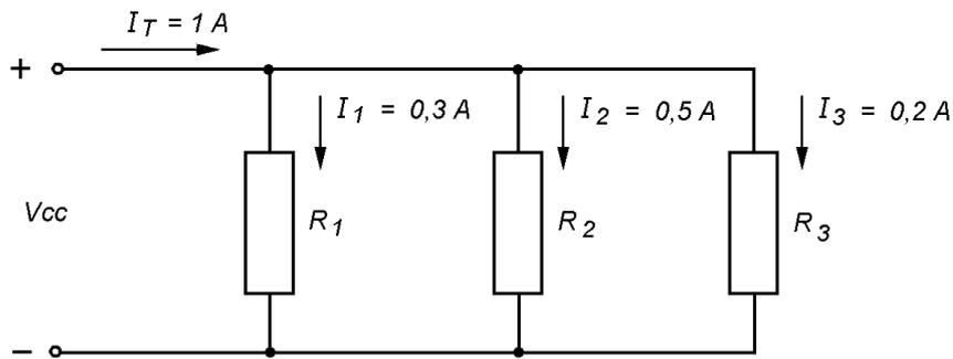
O valor da corrente elétrica em cada resistor depende do valor do resistor e da corrente total da associação.
