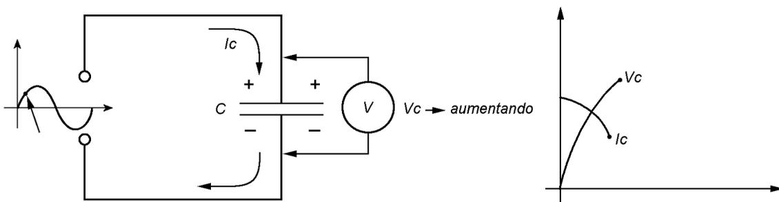
A corrente continua diminuindo até atingir o valor zero, no momento em que a tensão no capacitor se iguala à tensão da fonte.
