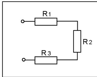
d) Determine a resistência equivalente entre os nós indicados em cada uma das associações de resistências.
