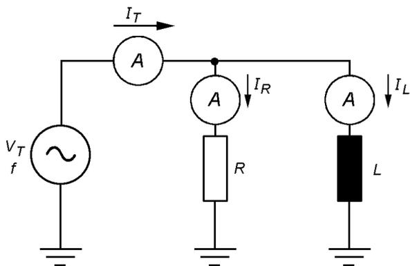
A corrente eficaz no resistor ( $I_R$ ) e no indutor ( $I_L$ ) é dada pela lei de Ohm:
