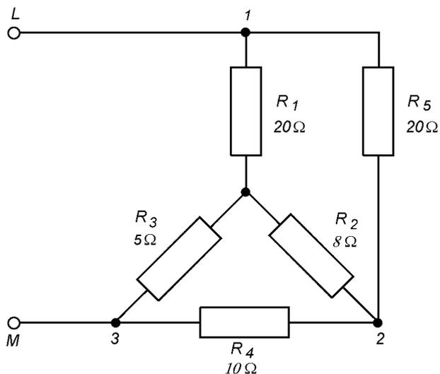
Os resistores  $R_1$ ,  $R_2$ , e  $R_3$ , que formam uma associação em estrela nos pontos 1, 2 e 3, podem ser substituídos por uma associação em triângulo conforme a figura que segue.
