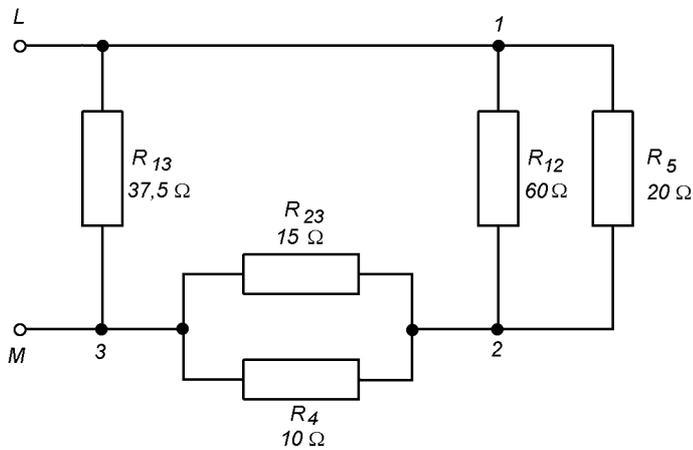
As associações em paralelo  $R_{12}/R_5$  e  $R_{23}/R_4$ , podem ser substituídas respectivamente por um resistor cada uma, identificados, por exemplo, por  $R_A$  e  $R_B$ .
