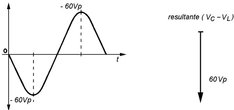
No exemplo dado, a resultante entre  $V_C$  e  $V_L$  corresponde a uma tensão de  $60V_p$  capacitiva porque a tensão  $V_C$  é maior que a tensão  $V_L$ .
