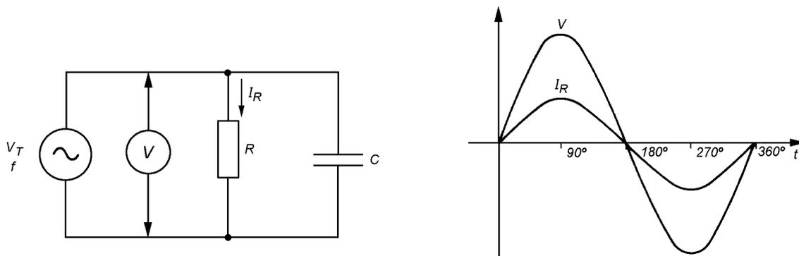
A mesma tensão aplicada ao resistor é aplicada sobre o capacitor, dando origem a uma corrente  $I_C$ .
