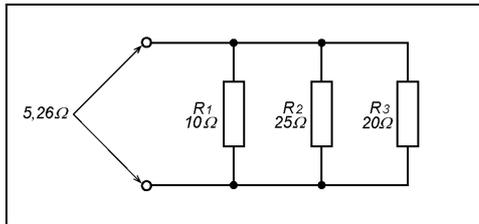
O resultado encontrado comprova que a resistência equivalente da associação em paralelo (5,26Ω) é **menor** que a resistência de **menor** valor (10Ω).
