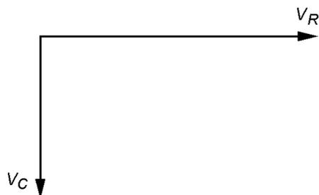
Matematicamente, se todos os vetores do sistema forem divididos por um único valor, o sistema não se altera. Dividindo-se os vetores pelo valor  $I$  (corrente), obtém-se:
