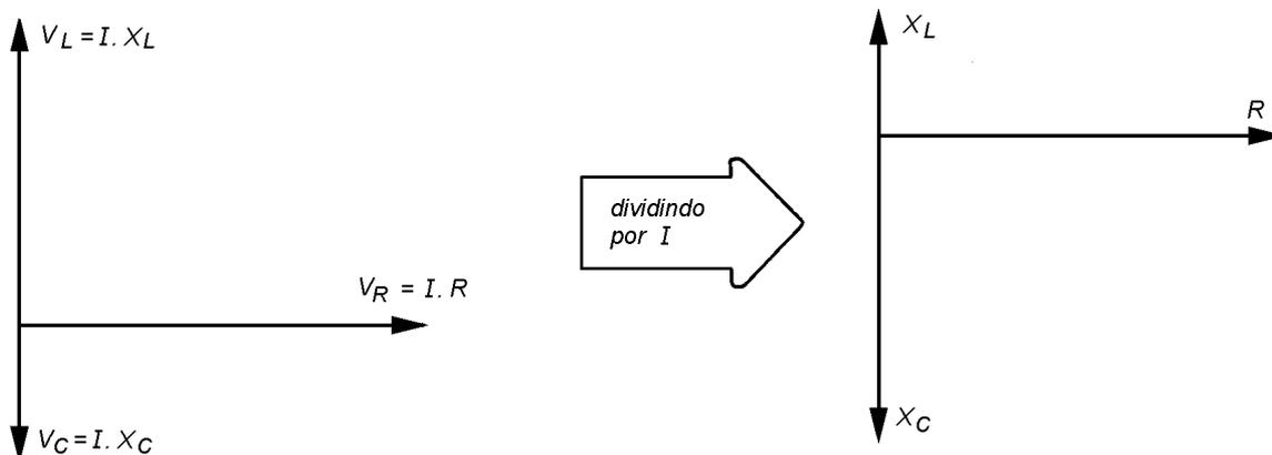
Pelo novo gráfico vetorial observa-se que  $X_L$  e  $X_C$  estão em oposição de fase (vetores na mesma direção e sentidos opostos). Com base nessa observação, o sistema de três vetores ( $X_L$ ,  $R$  e  $X_C$ ) pode ser reduzido para dois vetores:
