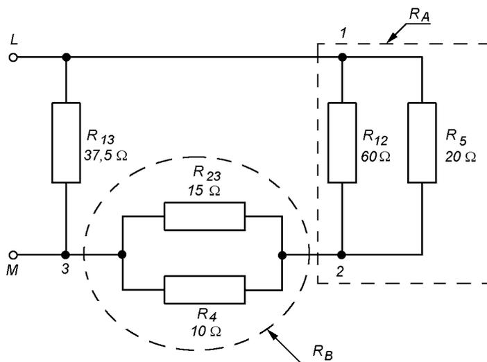
Para o cálculo de resistência equivalente em uma associação em paralelo com dois resistores, usa-se a equação a seguir.
