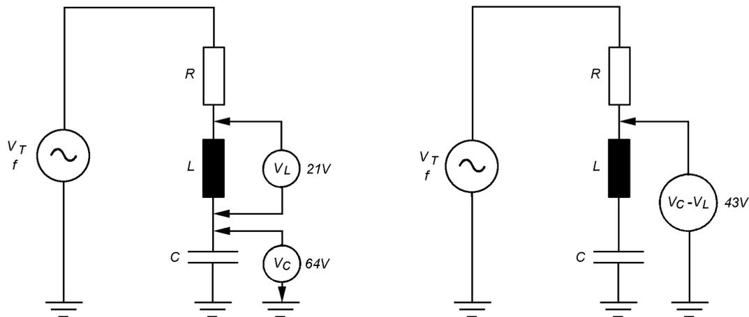
Nos diagramas mostrados, a tensão resultante entre L e C é capacitiva porque a tensão  $V_C$  é maior que a tensão  $V_L$ .
