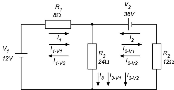
$$I_1 = I_{1-V1} - I_{1-V2} = 0,75 - 1,5 \quad \mathbf{I_1 = -0,75 A \text{ ou } -750 mA}$$
