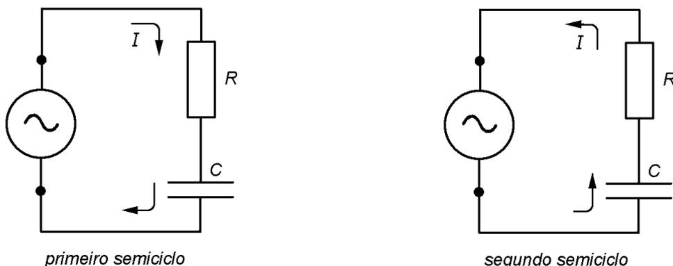
A corrente circulante tem a forma senoidal e pode ser representada através de um gráfico.
