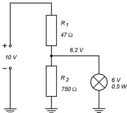
$$V_{R2} = I_{R2} \cdot R_2 = 0,0083 \cdot 750 = \mathbf{6,2 \text{ V}}$$
