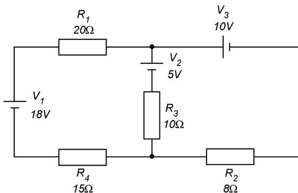
Esse circuito é formado por duas malhas que podem ser chamadas de *malha 1* e *malha 2*, e dois nós que podem ser identificados por **A** e **B**, conforme figura a seguir.
