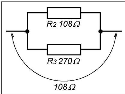
Portanto, as resistências associadas  $R_2$  e  $R_3$  apresentam  $108 \Omega$  de resistência à passagem da corrente no circuito.
