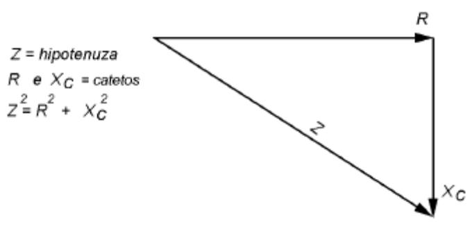
Isolando o valor de  $Z$ , obtém-se a equação para o cálculo da impedância do circuito RC série, ou seja,  $Z^2 = R^2 + X_C^2$ .
