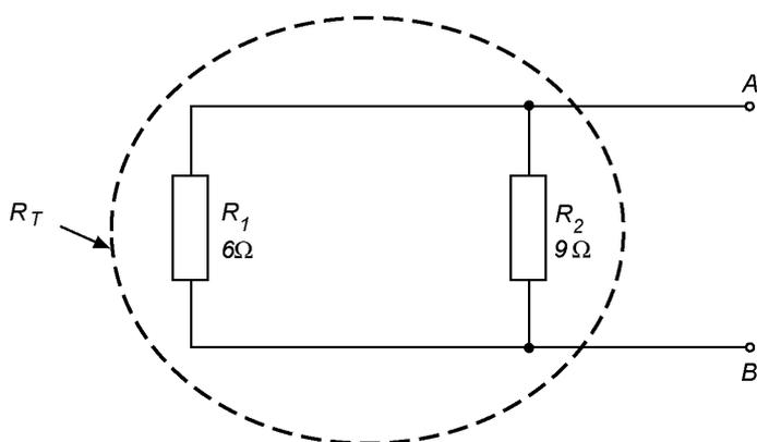
O valor do resistor  $R_{EQ}$ , pode ser calculado pela equação:
