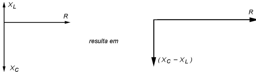
A partir do sistema de dois vetores a  $90^\circ$ , a resultante pode ser determinada pelo teorema de Pitágoras.
