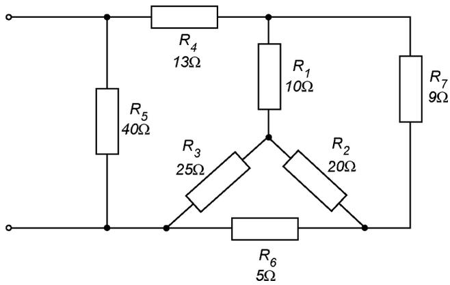
b) Calcule as correntes nos ramos e as tensões nos resistores no circuito apresentado.
