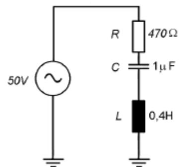
O que se verifica é que, na frequência de ressonância, os efeitos capacitivos e indutivos **se anulam mutuamente**. Isso faz com que a impedância seja mínima e igual ao valor do resistor. Portanto, um circuito RLC em série tem a impedância mínima na frequência de ressonância.
