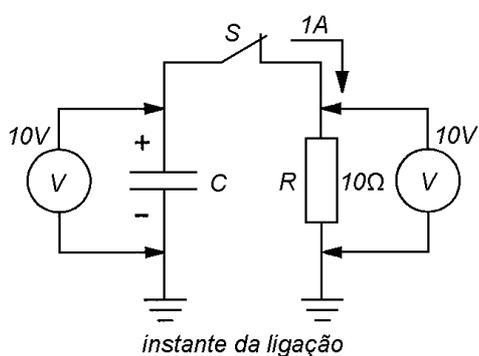
Entretanto, essa corrente existe apenas durante um curtíssimo espaço de tempo, porque com corrente de descarga alta, o capacitor se descarrega rapidamente. Graficamente a tensão no capacitor nos momentos iniciais pode ser representada pelo gráfico a seguir.
