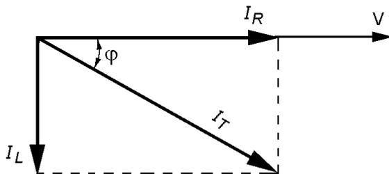
O ângulo  $\phi$  ( $\varphi$ ) entre  $I_R$  e  $I_T$  pode ser determinado a partir da relação que determina o cosseno:
