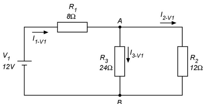
Vamos determinar a resistência equivalente do circuito. Como os resistores  $R_2$  e  $R_3$  estão em paralelo, podem ser substituídos por um único resistor,  $R_A$ .
