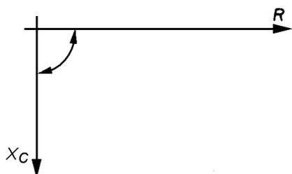
O gráfico mostra que a resistência ôhmica do resistor e a reatância capacitiva do capacitor estão defasadas em  $90^\circ$ .
