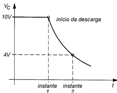
Quanto menor a tensão restante no capacitor, menor a corrente de descarga e mais lentamente o capacitor se descarrega.
