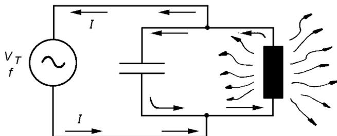
A corrente absorvida pelo indutor provém quase totalmente da descarga do capacitor. A fonte de CA repõe apenas a energia dissipada nas perdas do circuito.
