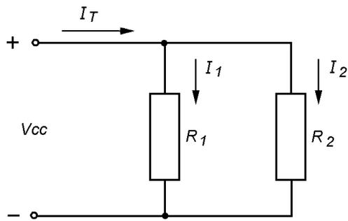
A resistência equivalente ou total nesse circuito pode ser calculada pela equação:
