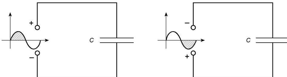
A cada semiciclo, a armadura que recebe potencial positivo entrega elétrons à fonte, enquanto a armadura que está ligada ao potencial negativo recebe elétrons.
