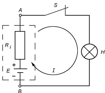
A corrente que circula através da resistência interna provoca uma **queda de tensão  $V_{ri}$** .
