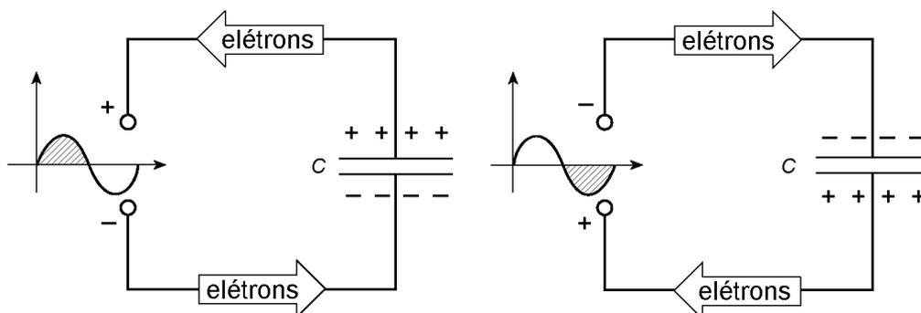
Existe, portanto, um movimento de elétrons ora entrando, ora saindo da armadura. Isso significa que **circula uma corrente alternada no circuito**, embora as cargas elétricas **não passem de uma armadura do capacitor para a outra** através do dielétrico.
