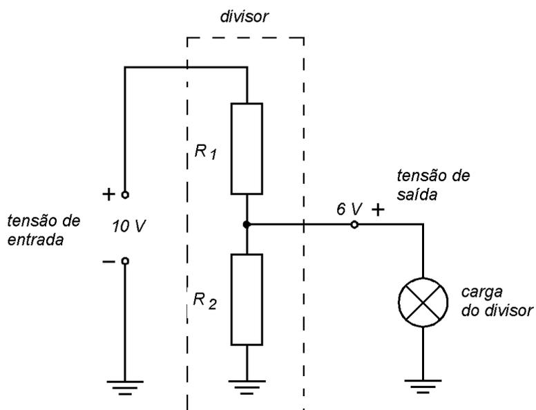
A carga de um divisor pode ser um componente eletrônico, uma lâmpada ou até um circuito. Por essa razão, quando se calcula ou representa um divisor em um diagrama, a carga é simbolizada simplesmente por um bloco, denominado  $R_L$ , independente dos componentes pelos quais ele realmente é formado.
