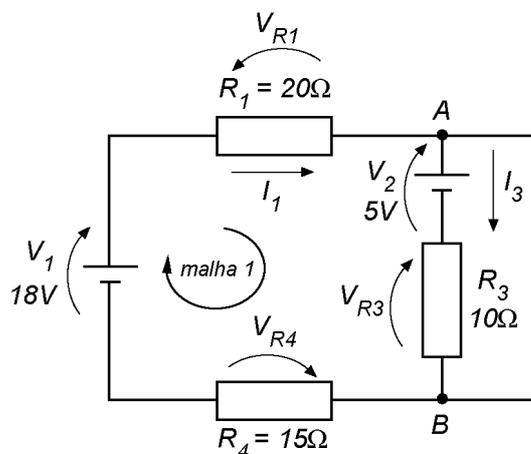
$$+ V_1 - V_{R1} - V_2 - V_{R3} - V_{R4} = 0$$
