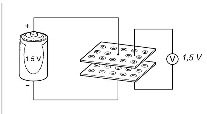
Quando o **capacitor** assume a **mesma tensão da fonte** de alimentação diz-se que o capacitor está "**carregado**".
