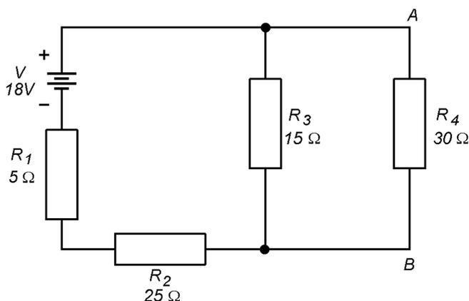
**Passo 1:** Determinação da resistência equivalente de Thévenin do circuito apresentado.
