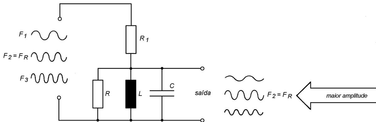
Como podemos ver, as frequências diferentes de  $f_r$  sofreram maior redução de nível no divisor. Aplicando a saída deste divisor à entrada de outro com a mesma frequência de ressonância, o fenômeno se repete.
