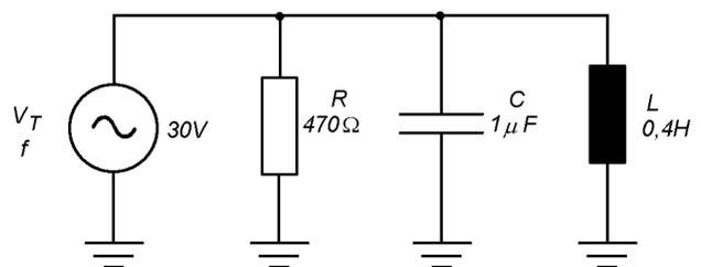
No circuito RLC em paralelo, a corrente total tem um valor mínimo na frequência de ressonância ( $I_{T \text{ MIN}}$ ).
