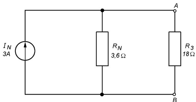
Para determinar a corrente no resistor  $I_3$ , utiliza-se a equação a seguir.
