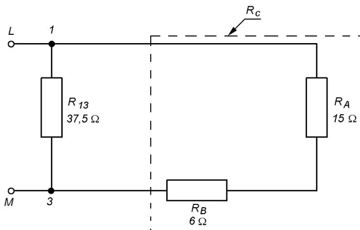
A resistência equivalente  $R_C$  pode ser calculada pela equação:
