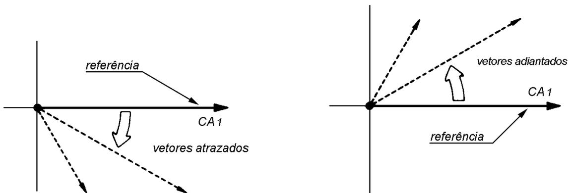
No gráfico senoidal abaixo a **CA<sub>2</sub> está atrasada 90°** com relação a CA<sub>1</sub> de forma que o gráfico vetorial se apresenta conforme a figura que segue.
