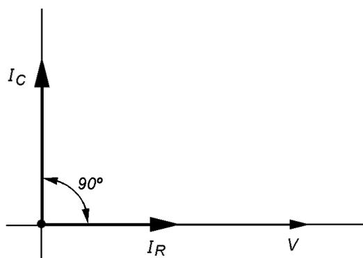
O gráfico vetorial mostra a tensão aplicada, a corrente no resistor em fase com a tensão aplicada e a corrente no capacitor adiantada 90°.
