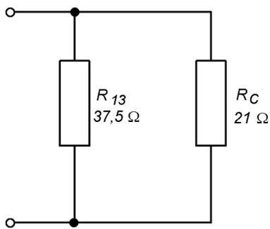
Novamente temos dois resistores em paralelo,  $R_{13}/R_C$ , que podem ser substituídos por um resistor, resistor,  $R_{LM}$ .
