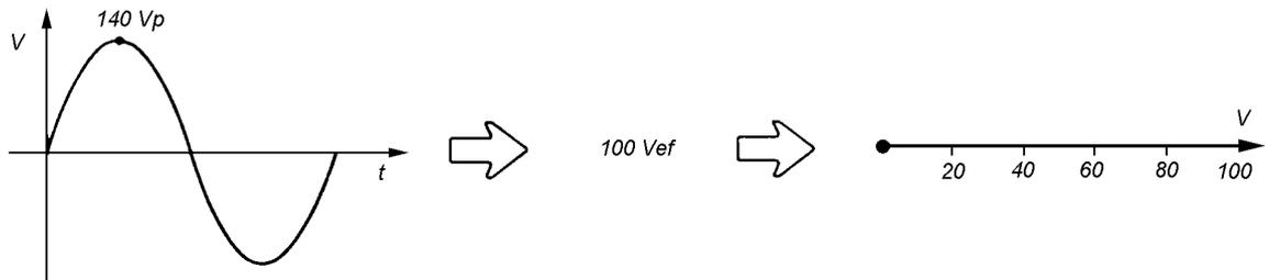
O sistema de gráficos vetoriais permite a representação de qualquer número de tensões em quaisquer defasagens. O ângulo de defasagem entre as CA's é representado graficamente por um ângulo entre os vetores.
