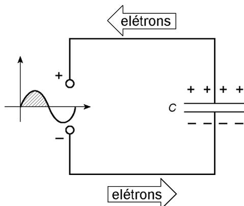
Com a troca sucessiva de polaridade, uma mesma armadura durante um semiciclo recebe elétrons da fonte e no outro devolve elétrons para a fonte.
