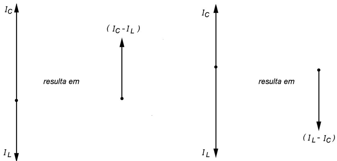
Uma vez que o sistema de três vetores foi reduzido a dois vetores defasados em  $90^\circ$ , a resultante pode ser determinada pelo **teorema de Pitágoras**.
