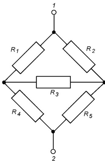
Nessa associação o resistor  $R_3$  não está em série e nem em paralelo com qualquer outro resistor.
