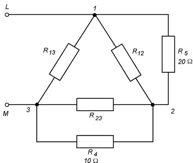
Para o dimensionamento dos resistores da associação em triângulo  $R_{12}$ ,  $R_{23}$  e  $R_{13}$ , utiliza-se as seguintes equações:
