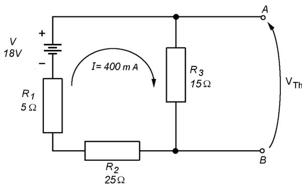
A tensão equivalente de Thévenin é igual à tensão no resistor  $R_3$ , ou seja,  $V_{R3}$ .
