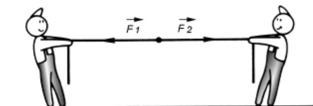
Esse é um exemplo típico de um sistema onde as forças atuam na **mesma direção** (a da corda), mas em **sentidos opostos**. Considerando a corda como ponto de aplicação das forças, o sistema pode ser representado conforme a figura a seguir.
