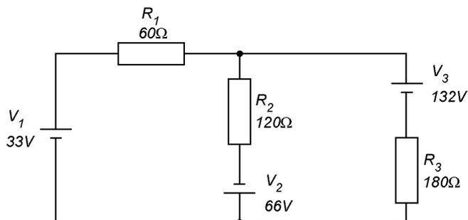
d) Determinar as potências dissipadas nos resistores.
