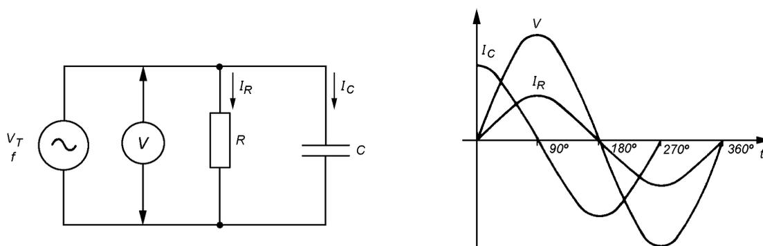
O gráfico mostra que o circuito provoca uma defasagem entre as correntes no resistor e no capacitor. Veja a seguir o gráfico de vetores correspondente.
