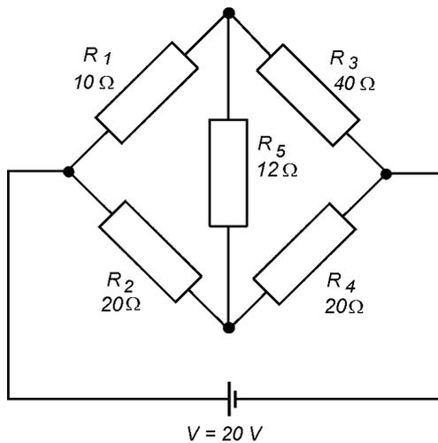
b) Determinar a potência dissipada no resistor  $R_3$ .
