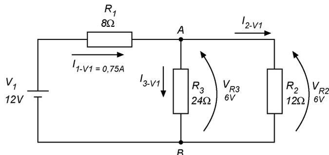
De acordo com o circuito apresentado, é possível calcular as correntes secundárias  $I_{2-V1}$  e  $I_{3-V1}$ , ou  $I_{21}$  e  $I_{31}$ , utilizando a lei de Ohm.
