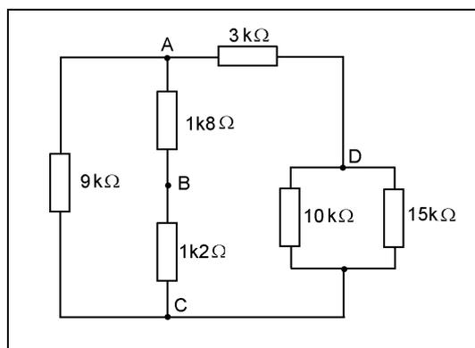
⇒ A resistência equivalente, vista dos pontos A e C (ou seja, considerando os pontos A e C como terminais do circuito).
