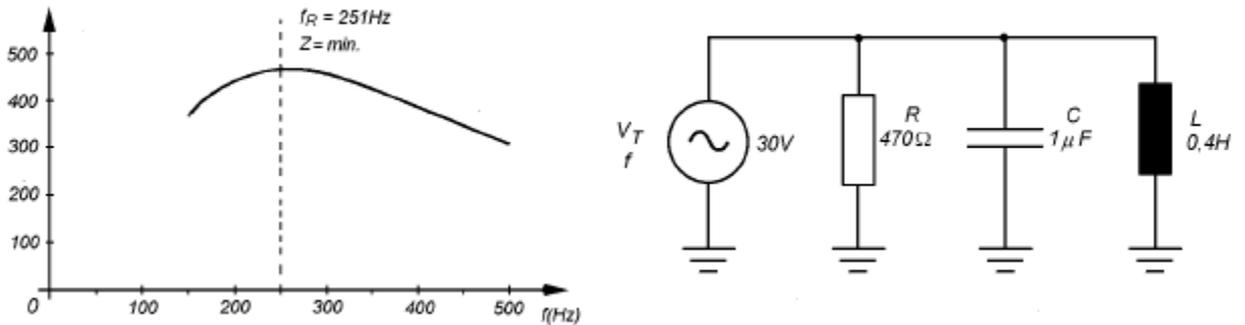
**Resumindo:** Na frequência de ressonância, a impedância de um circuito RLC em paralelo é máxima.
