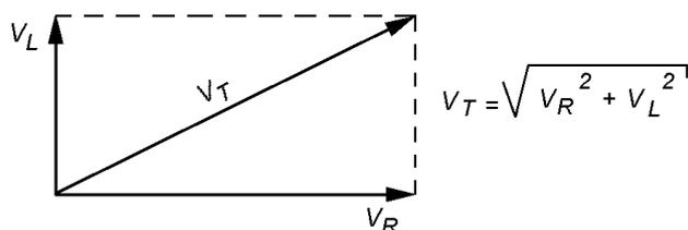
Onde  $V_T$  é a tensão eficaz aplicada ao circuito em volts;
