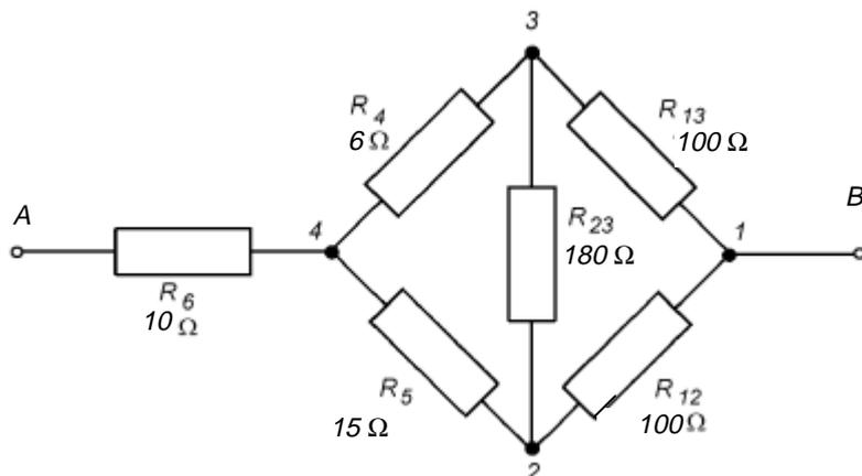
Os resistores  $R_{12}$ ,  $R_{23}$ , e  $R_{13}$ , que formam uma associação em triângulo nos pontos 1, 2 e 3. Eles podem ser substituídos por uma associação em estrela conforme a figura que segue.
