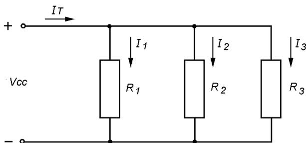
O circuito divisor de corrente serve para fornecer parte da corrente total do circuito, para um componente ou circuito.
