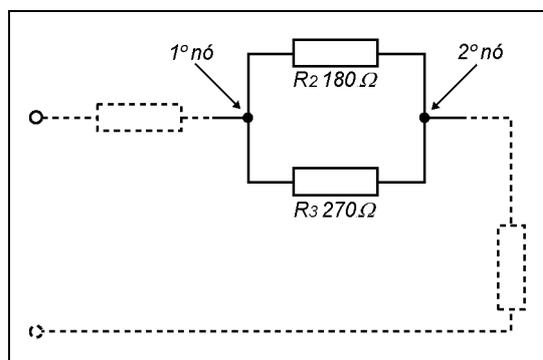
4. Determina-se então a  $R_{eq}$  dessas duas resistências associadas em paralelo, aplicando-se a fórmula a seguir.
