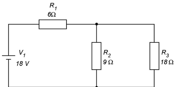
**Passo 1:** Determinação da resistência equivalente de Norton.
