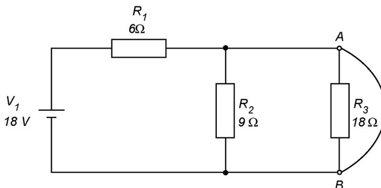
O curto-circuito entre os pontos A e B elimina as resistências  $R_2$  e  $R_3$ , ligadas em paralelo. O circuito equivalente é representado a seguir.
