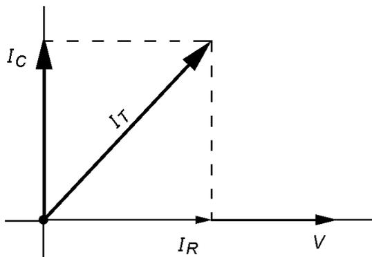
Os vetores  $I_R$ ,  $I_C$  e  $I_T$  formam um triângulo retângulo. Assim, a corrente total,  $I_T$  é calculada utilizando o teorema de Pitágoras.
