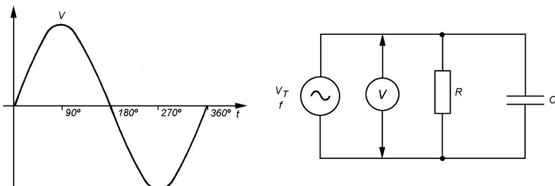
A aplicação de tensão alternada ao circuito provoca o aparecimento de uma corrente no resistor,  $I_R$ . Essa corrente está em fase com a tensão aplicada.
