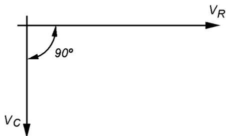
Como no caso da impedância, a tensão total é determinada pela resultante dos dois vetores, ou seja,  $V_T^2 = V_R^2 + V_C^2$ .
