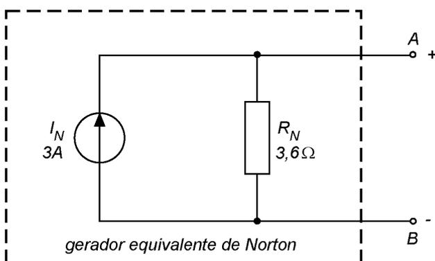
A corrente no resistor  $R_3$ ,  $I_{R_3}$ , pode ser calculada ligando-se novamente o resistor ao circuito, nos pontos A e B.
