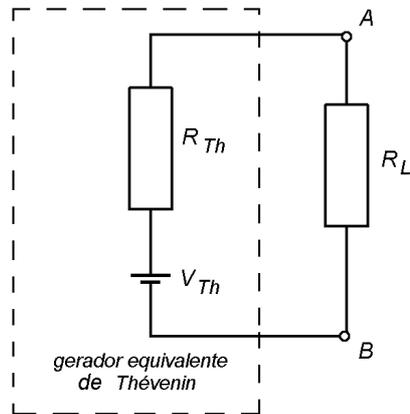
A **tensão equivalente de Thévenin** é o valor de tensão medido nos pontos A e B, considerando o circuito em aberto, ou seja, sem o componente em análise, resistência de carga  $R_L$ .
