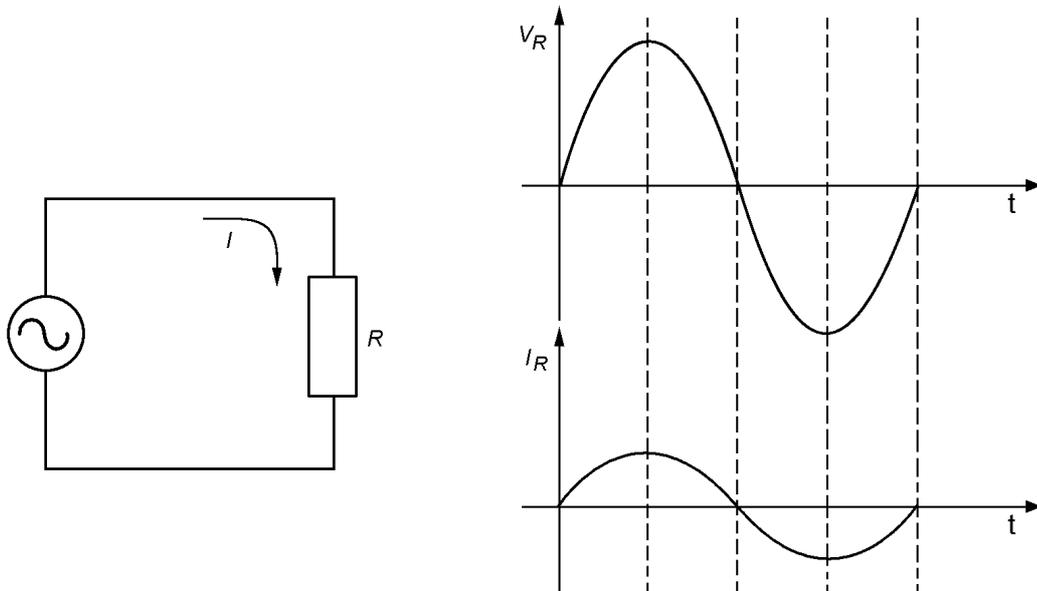
A corrente no resistor obedece à Lei de Ohm:  $I = V/R$ . Como o valor de  $R$  é fixo, a corrente é proporcional à tensão.
