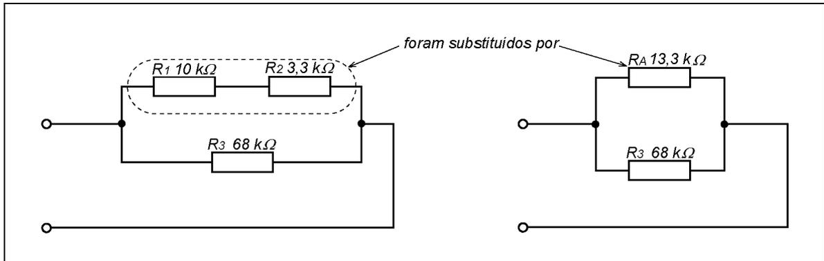
Da análise do circuito formado por  $R_A$  e  $R_3$ , deduz-se que essas resistências estão em paralelo e podem ser substituídas por uma única resistência, com o mesmo efeito.
