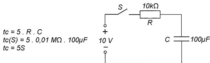
Isso significa que 5s depois do fechamento da chave S, a tensão sobre as armaduras do capacitor será igual a tensão da fonte CC, ou seja, 10 V.
