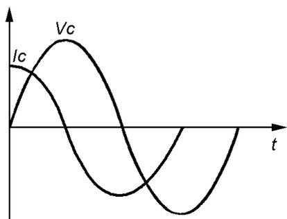
A defasagem pode ser representada através de um gráfico vetorial. Um vetor representa a tensão sobre o capacitor e o outro, a corrente no capacitor. Como corrente e tensão no capacitor estão defasadas  $90^\circ$ , os seus vetores são representados de tal forma que haja ângulo de  $90^\circ$  entre eles.
