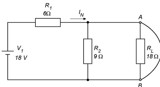
A **resistência equivalente de Norton** é a resistência equivalente entre os pontos A e B, após duas considerações: as fontes de tensões são **curto-circuitadas** e o bipolo de interesse,  $R_L$ , está **desligado** do circuito.
