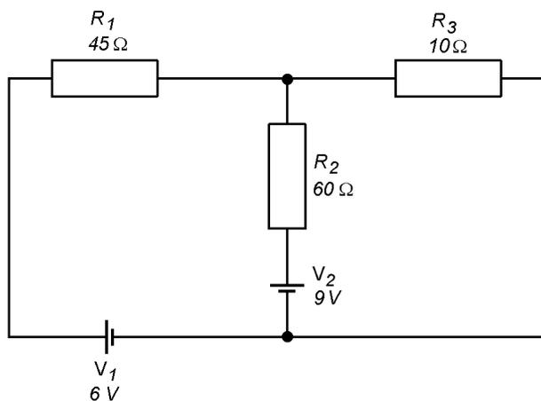
c) Calcule a potência dissipada no resistor  $R_1$ , no circuito que segue.
