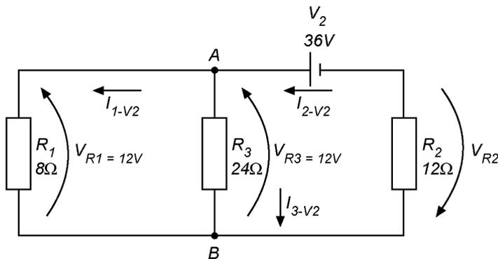
De acordo com o circuito apresentado, é possível calcular as correntes  $I_{1-V2}$  e  $I_{3-V2}$ , utilizando a lei de Ohm.
