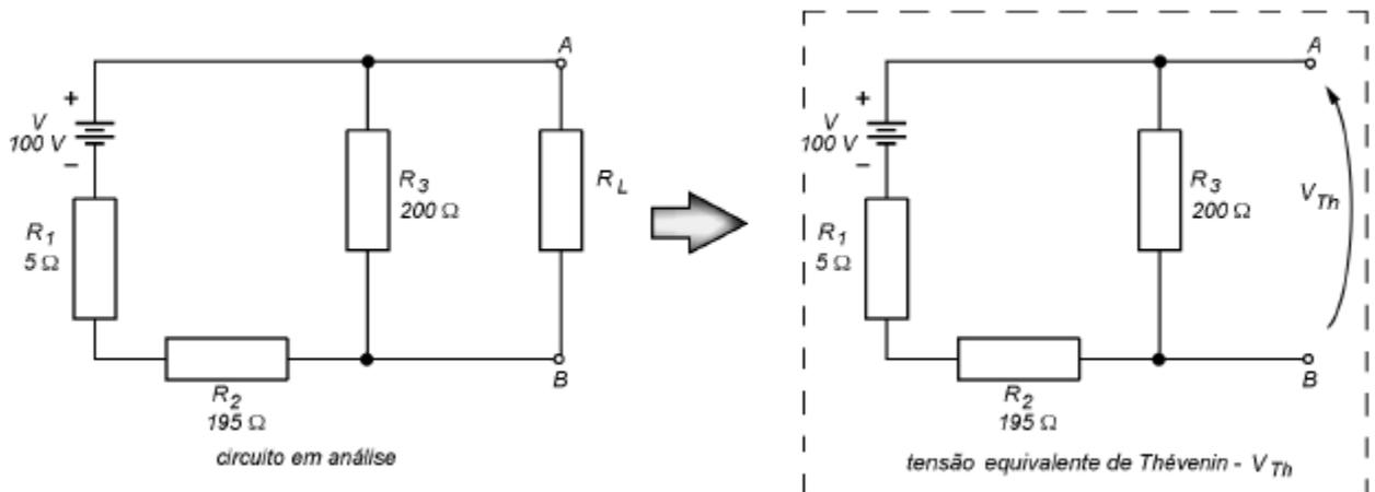
A **resistência equivalente de Thévenin** é a resistência equivalente entre os pontos A e B, após duas considerações: as fontes de tensões são curto-circuitadas e o bipolo de interesse,  $R_L$ , está desligado do circuito.
