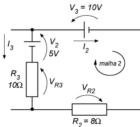
$$+ V_2 + V_{R3} - V_3 - V_{R2} = 0$$
