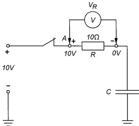
Com os dados disponíveis, é possível determinar a corrente inicial através do resistor que é também a corrente inicial de carga do capacitor.
