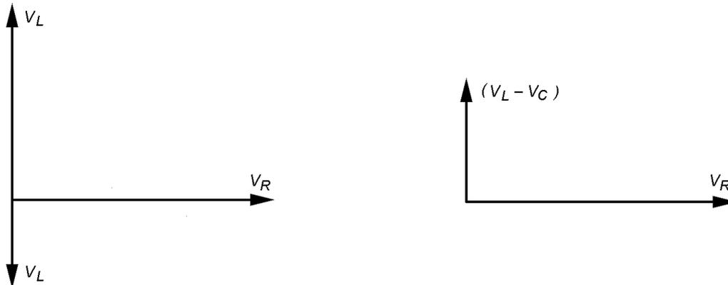
A partir do sistema de dois vetores a  $90^\circ$ , a tensão total  $V_T$  pode ser determinada pelo teorema de Pitágoras.
