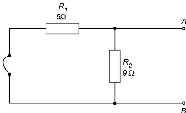
Na associação resultante, temos os resistores  $R_1$  e  $R_2$  em paralelo, que podem ser substituídos **por um único resistor equivalente**, que será chamado de  $R_{Eq}$  ou  $R_T$ .
