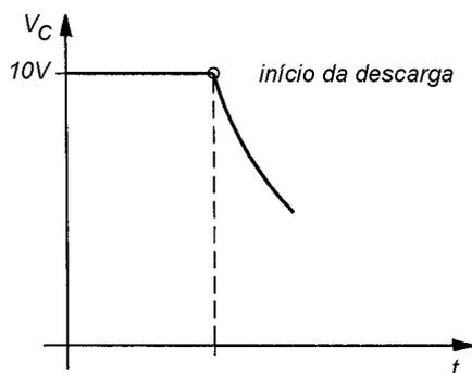
Num segundo momento, algum tempo após a ligação da chave, a tensão no capacitor já é bem menor que 10 V. Se a tensão sobre C for de 4 V, por exemplo, a corrente seria:
