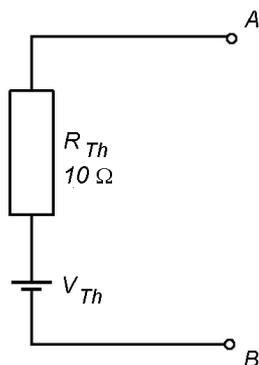
**Passo 2:** Determinação da tensão equivalente de Thévenin do circuito.
