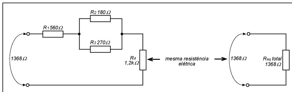
A seguir, é apresentado um exemplo de circuito misto, com a seqüência de procedimentos para determinar a resistência equivalente.
