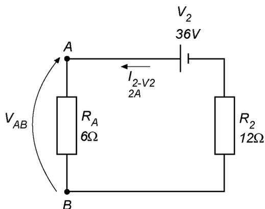
Utilizando a lei de Ohm é possível calcular a tensão, entre os pontos A e B:
