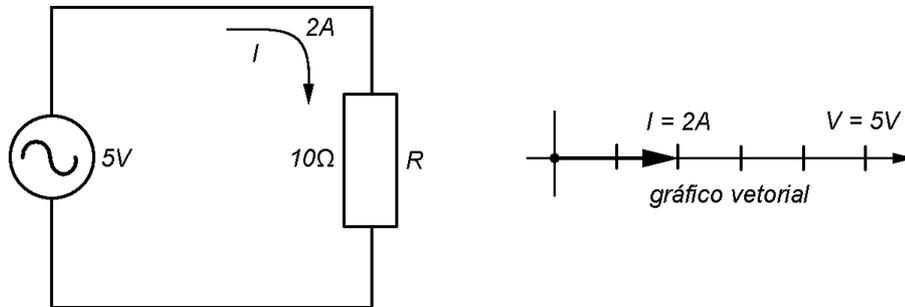
Como exemplos de cargas resistivas, onde tensão e corrente estão em fase, podem ser citados: resistores, lâmpadas, resistências de ferro de passar, de ferro de soldar, de aquecedor etc.
