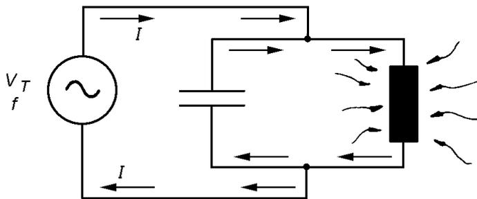
A corrente gerada pelo indutor é absorvida pelo capacitor que inicia um processo de recarga.
